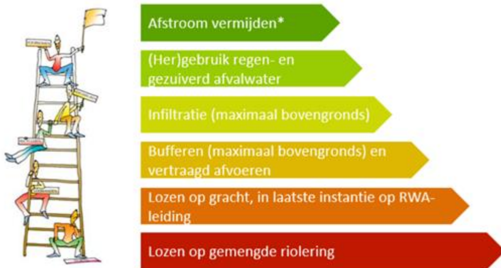
Figuur 13: Ladder van Lansink (*Afstroom vermijden kan door verharding te beperken, drainage te verminderen, ...). (Coördinatiecommissie Integraal Waterbeleid, 2021)
