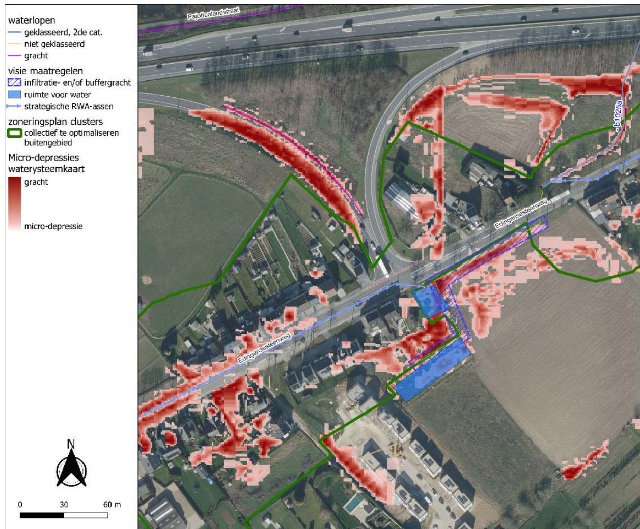
Figuur 27: Locatie langs de Edingensesteenweg waar de niet geklasseerde bovenloop van waterloop B1025a ingezet kan worden als infiltratie- en/of buffergracht met extra ruimte voor water. De micro-depressies uit de watersysteemkaart en de groene clusters uit het zoneringsplan worden eveneens weergegeven.
